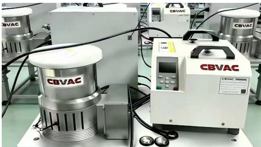
Пример интеграции SSH20 с высоковакуумной ступенью CBVAC. Изображение из каталога производителя.
